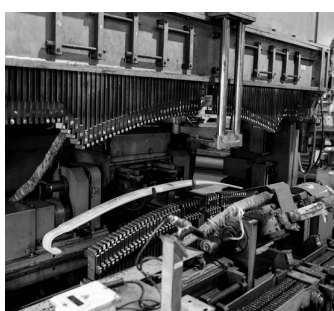
くし歯成形機でリーフの反り(キャンパー)を調整。
